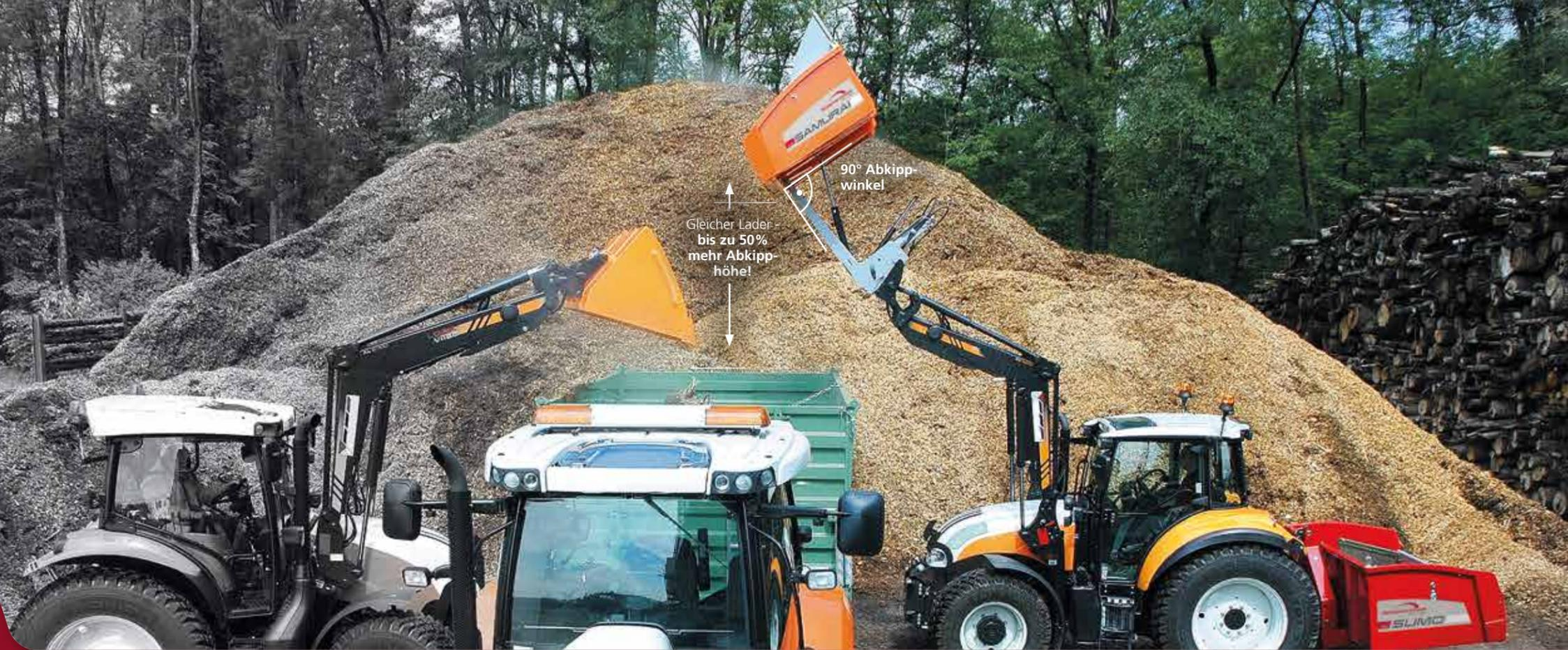
Laderschaufeln kippen an der Aufhängung nach unten. Im Gegensatz dazu sind Dreipunkt-Laster Hochkippschaufeln. Sie heben hinten an, über den Drehpunkt an der Vorderseite der Schaufel. Alleine dadurch ist deutlich mehr Abkipphöhe möglich.
